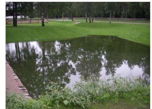
Figur 5-2 Nedsenkede områder i grønt-/parkområder tilrettelagt for kontrollert oversvømmelse. Til venstre fra Berlin og til høyre fra Växjö etter en regnhendelse (foto; Drammen kommune og Göran Lundgren).
